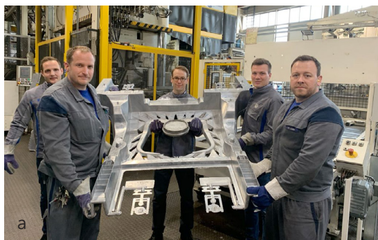
Rys. 3. Odlewy ze stopu aluminium (a), (b), wykonane na maszynie ciśnieniowej o sile zwierania 4.400 ton w odlewni Volkswagena w Kassel, Niemcy (projekt pilotażowy) [7]
