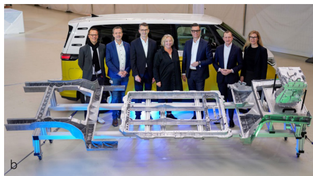
Rys. 3. Odlewy ze stopu aluminium (a), (b), wykonane na maszynie ciśnieniowej o sile zwierania 4.400 ton w odlewni Volkswagena w Kassel, Niemcy (projekt pilotażowy) [7]
